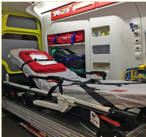
FIGURA 2. Camilla de la unidad utilizada durante el estudio que permite una elevación pasiva de piernas de 30°.
