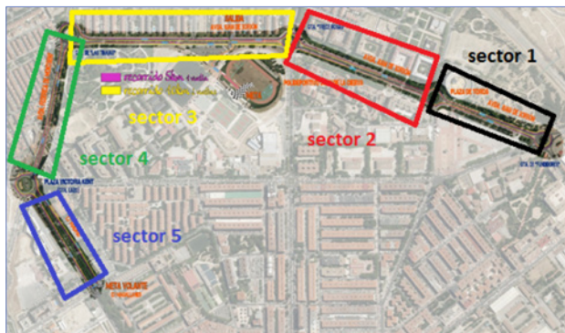
FIGURA 4. División del circuito en sectores, a fin de mejorar la localización del incidente.
