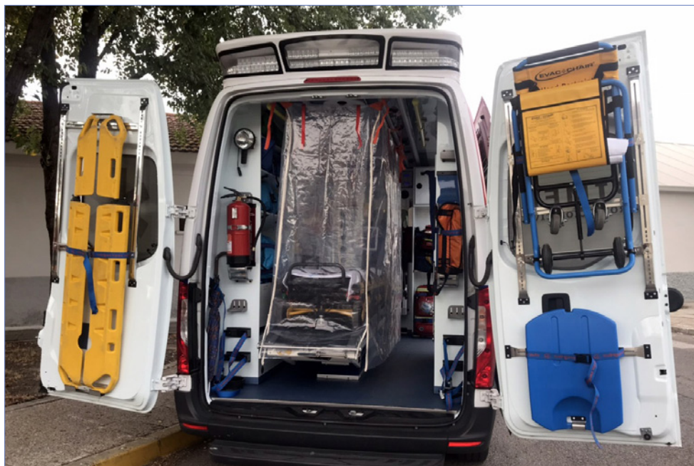
FIGURA 1. Ambulancia tipo B del Servicio de Emergencias Municipal PIMER-Protección Civil del Ayuntamiento de Pinto (Madrid) con sistema de cortina Tanit®; disposición desplegada. Vista trasera.
