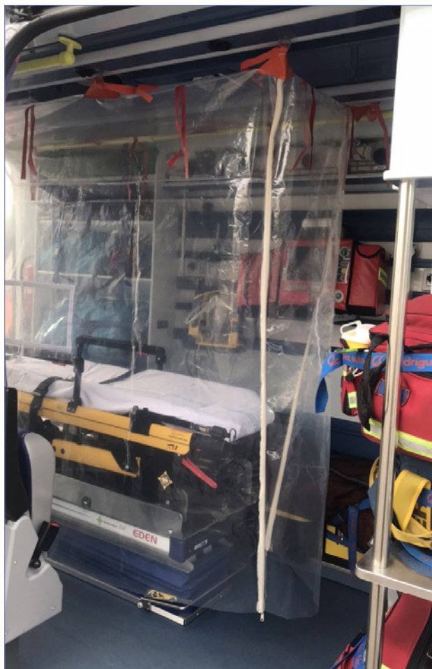
FIGURA 2. Ambulancia tipo B del Servicio de Emergencias Municipal PIMER-Protección Civil del Ayuntamiento de Pinto (Madrid) con sistema de cortina Tanit®; disposición desplegada para su uso con pacientes confirmados o sospechosos de COVID-19. Vista lateral.
