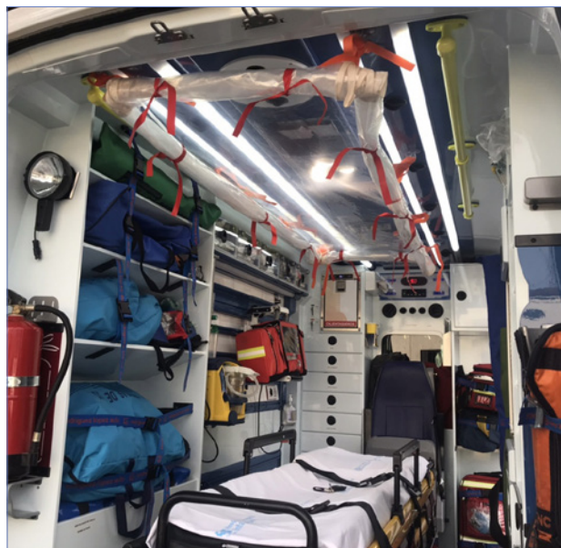
FIGURA 3. Ambulancia tipo B del Servicio de Emergencias Municipal PIMER-Protección Civil del Ayuntamiento de Pinto (Madrid) con sistema de cortina Tanit® en disposición plegada usada durante la asistencia y traslado de pacientes NO covid-19.
